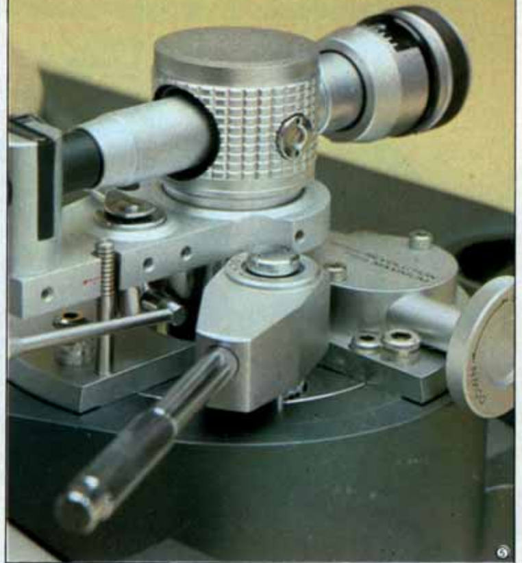
5. Il manettino serve a regolare l'altezza del braccio; la grossa leva a bloccarlo una volta effettuata la regolazione
